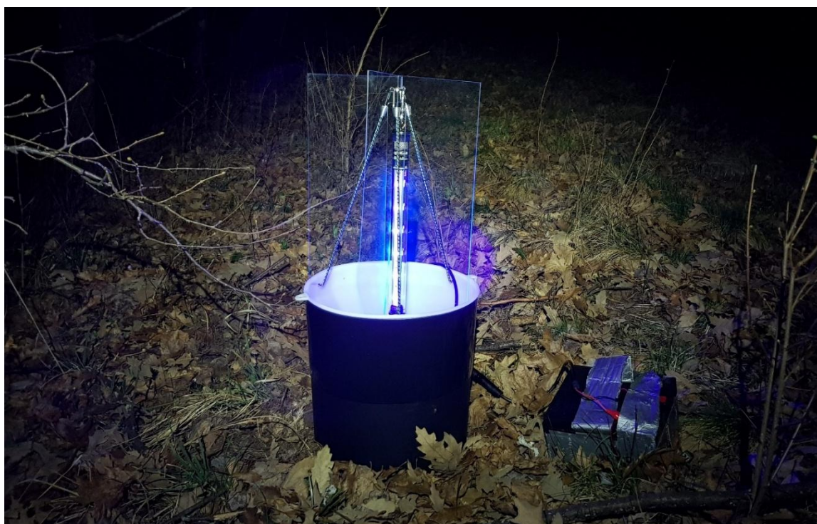
Slika 9: Avtomatska LED svetlobna past razvita na Češkem, s programiranjem časa delovanja z mobilno aplikacijo, ki niso več dobavljive. (foto: Stanislav Gomboc, 24. 3. 2019)
