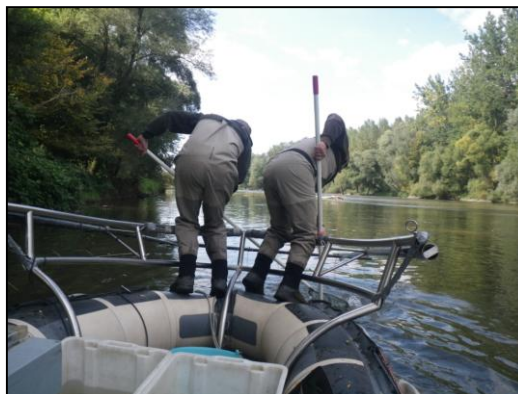
Slika 1: Izvajanje elektroribolova s čolna.
