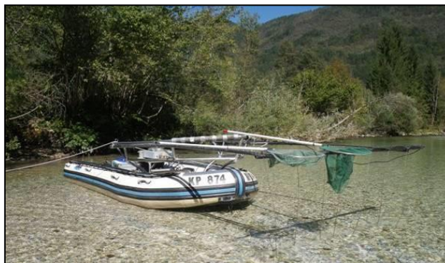
Slika 4: Čoln z opremo za kvantitativni elektroribolov. Anode so stacionarne in nameščene na premcu čolna.
