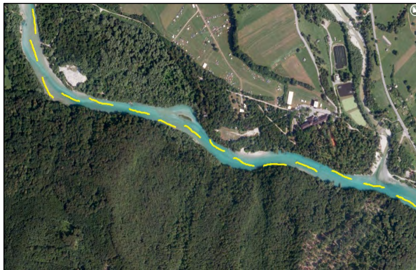
Slika 3: Shema vzorčenja (posamezni vzorčeni pasovi so obarvani rumeno).
